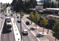
Seftingsstrasse, Kitz, vorher/nachher: Neuordnung des Strassenraums: kompakt & effizient, mit Mehrzweckstreifen und Velo-Infrastruktur
